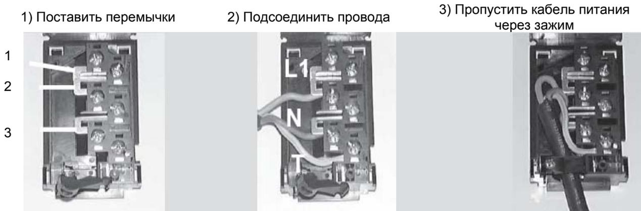
**Внимание: Недостаточное усилие при зажиме концов проводов может вызвать чрезмерный нагрев питающего кабеля.**
