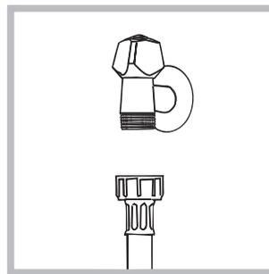
1. Прикрутите шланг подачи к водопроводному крану холодной воды с резьбовым отверстием 3/4 газ, (см. схему).
